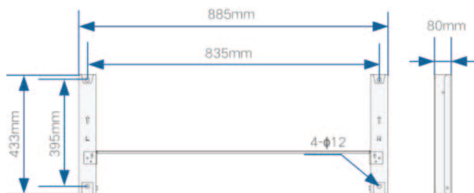
Figura 4-1 Dimensões do suporte de instalação
